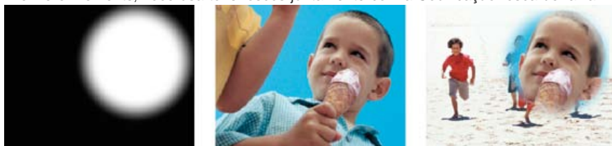
Fosco (esquerda) define áreas transparentes em um clipe superior (central), revelando clipes inferiores (direita)
