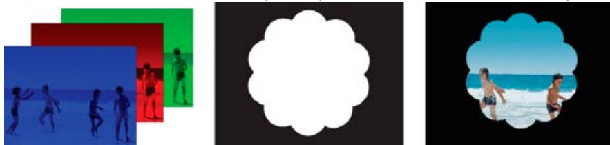
Canais de cores separados Vermelho, Verde e Azul (esquerda); o canal alfa ou a máscara (central), e todos os canais exibidos juntos (direita)
