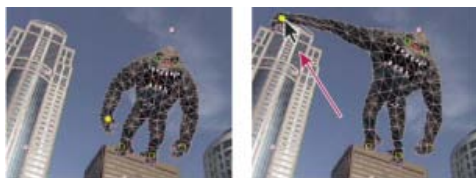
Сетка, созданная путем установки булавок деформации (слева), и результат перетаскивания булавки деформации
